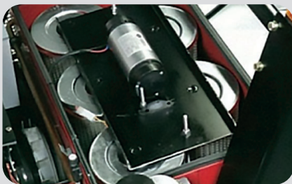
Die große Filteranlage gewährleistet eine perfekte Staubabsaugung
