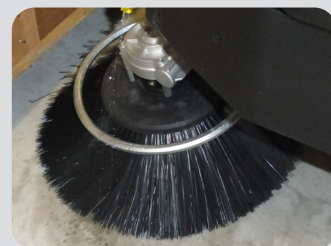
Seitenbesen mit Wasser-Sprüheinrichtung.
